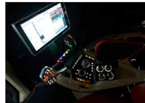
Los iconos de todos los interruptores se retroiluminan al encender los faros.
