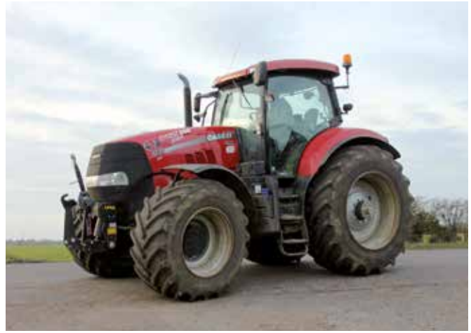
La velocidad máxima de 50 km/h se alcanza a un régimen de tan solo 1.500 rpm, incluso con remolque, una gran ventaja de la transmisión CVX.
